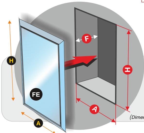
DIMENSIONES DEL HUECO PARA INSTALACIÓN EMPOTRAMIENTO
