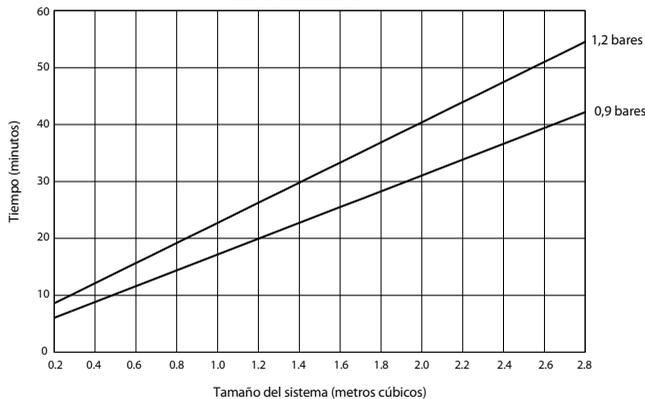
Tiempo estimado para alcanzar diversos valores de presión - Opción de 220 V, Serie 7C7 con compresor de 1/3 hp (220 a 240 VCA, 60 Hz) sin venteo automático
