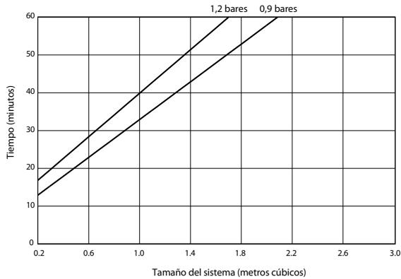
Tiempo estimado para alcanzar diversos valores de presión - Opción de 220 V, Serie 7C7 con compresor de 1/3 hp (220 a 240 VCA, 50 Hz) sin venteo automático
