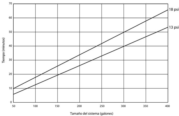
Tiempo estimado para alcanzar diversos valores de presión - Serie 7C7 con compresor de 1/6 hp (110 VCA) sin venteo automático
