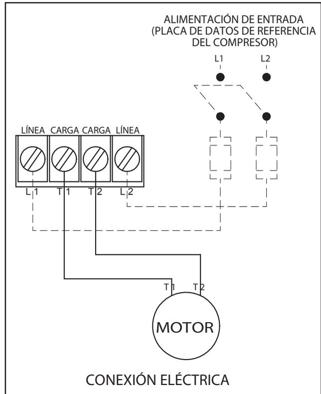
NOTA: Gabinete NEMA 1: destinado únicamente para uso en interiores Solamente electricistas certificados deben hacer la conexión a la alimentación de entrada. Todo el cableado se debe completar de conformidad con las normas de la autoridad local que tenga jurisdicción en el lugar y de conformidad con todos los códigos eléctricos vigentes.
