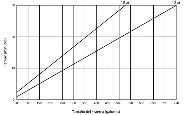
Tiempo estimado para alcanzar diversos valores de presión - Opción de 220 V, Serie 7C7 con compresor de 1/3 hp (220 a 240 VCA, 50 Hz) y venteo automático
