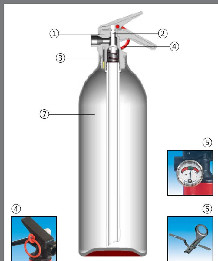
① La Válvula inalterable fabricada directamente en resina acetálica para garantizar una total protección contra la corrosión. Equipado de un boquilla difusora de diseño propio que garantiza la máxima descarga de producto extintor en el menor tiempo, siempre de acuerdo con la normativa vigente.
