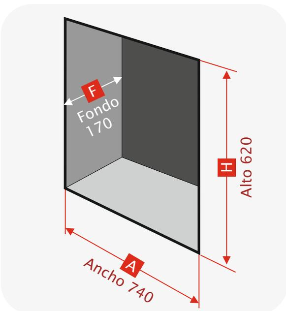
**DIMENSIONES DEL HUECO PARA INSTALACIÓN EMPOTRAMIENTO**
