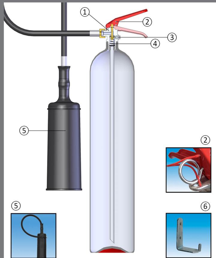
① La válvula esta fabricada en laton estampado y nickelado.
