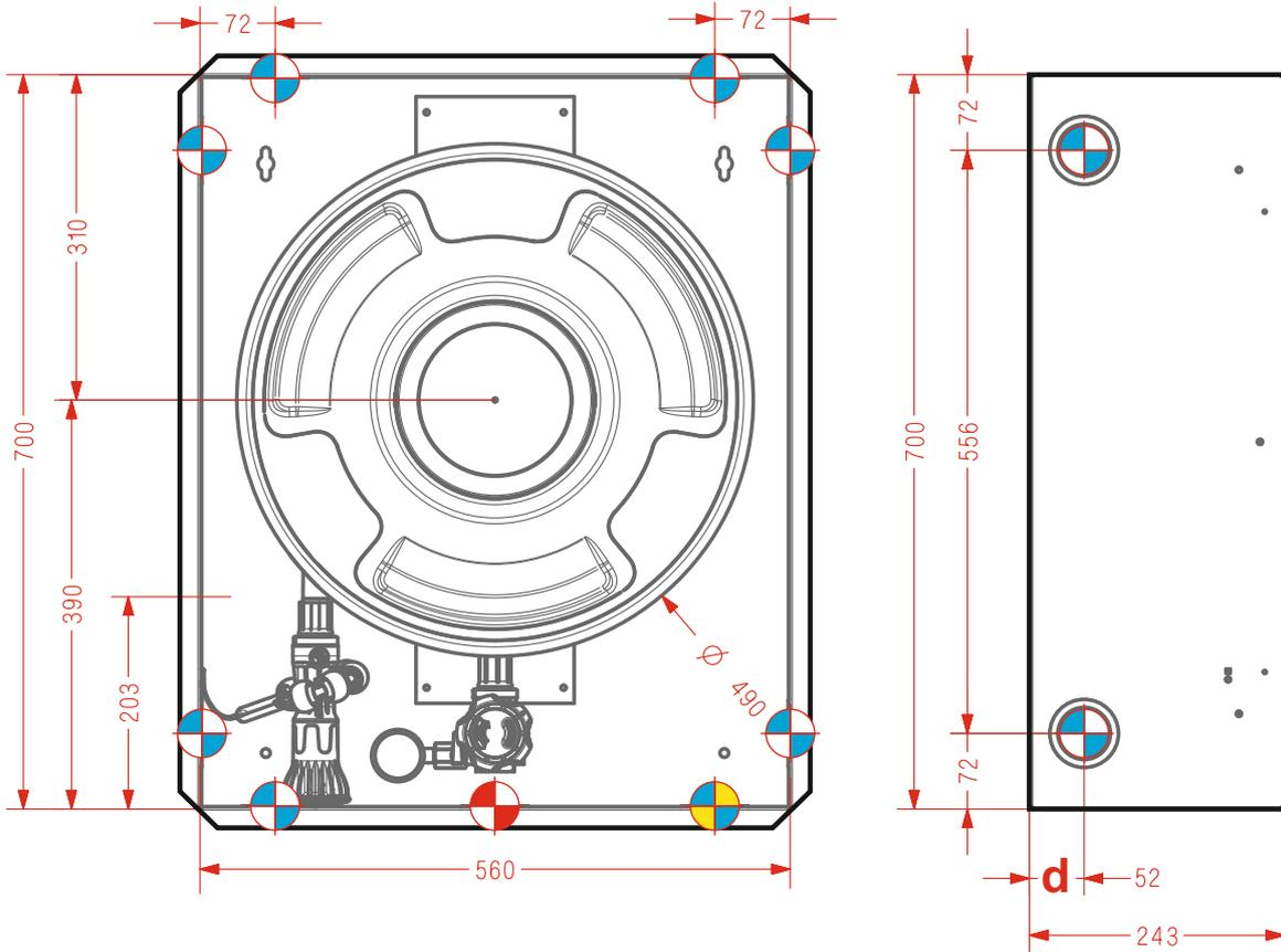
**DIMENSIONES DEL HUECO PARA INSTALACIÓN EMPOTRAMIENTO**
