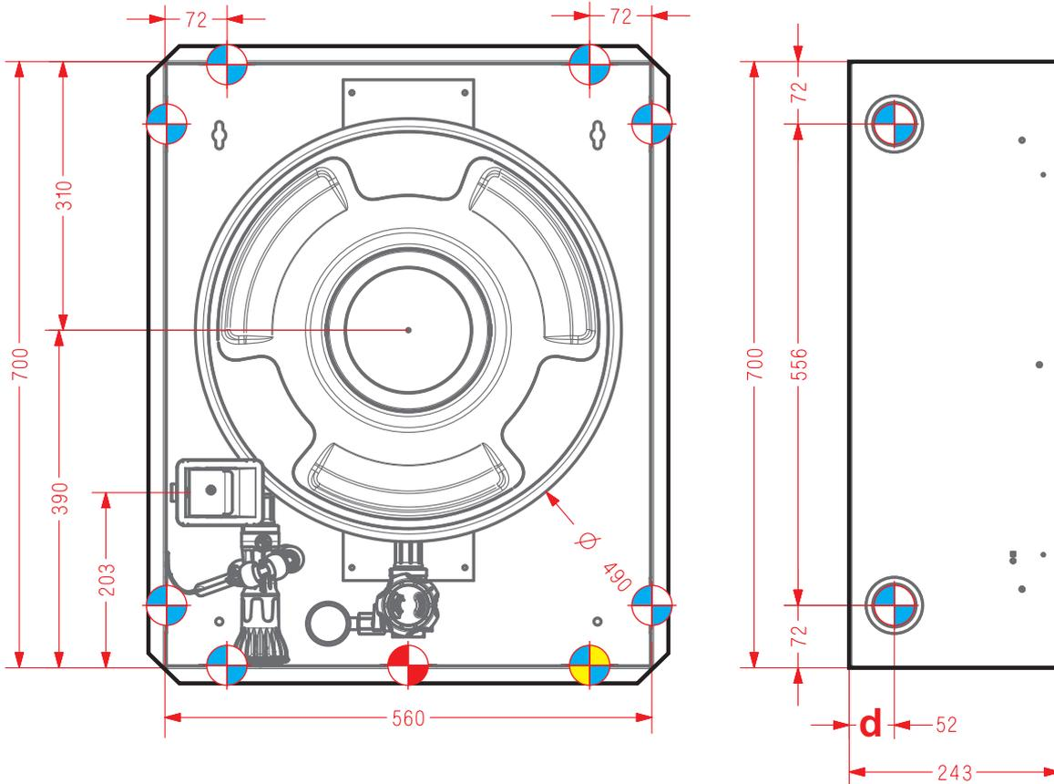
**DIMENSIONES DEL HUECO PARA INSTALACIÓN EMPOTRAMIENTO**
