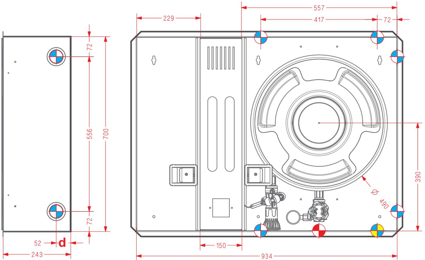
**DIMENSIONES DEL HUECO PARA INSTALACIÓN EMPOTRAMIENTO**
