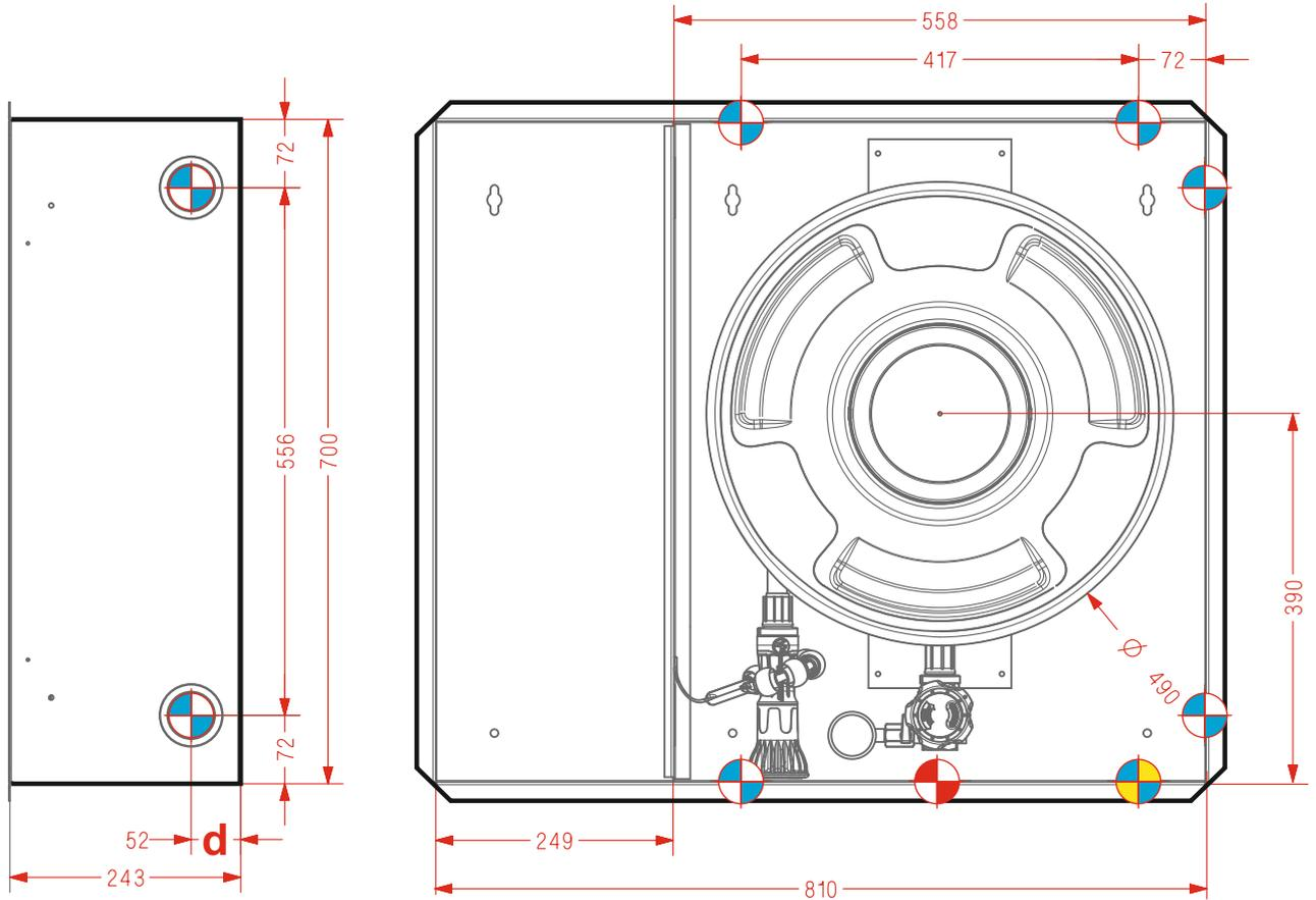
**DIMENSIONES DEL HUECO PARA INSTALACIÓN EMPOTRAMIENTO**
