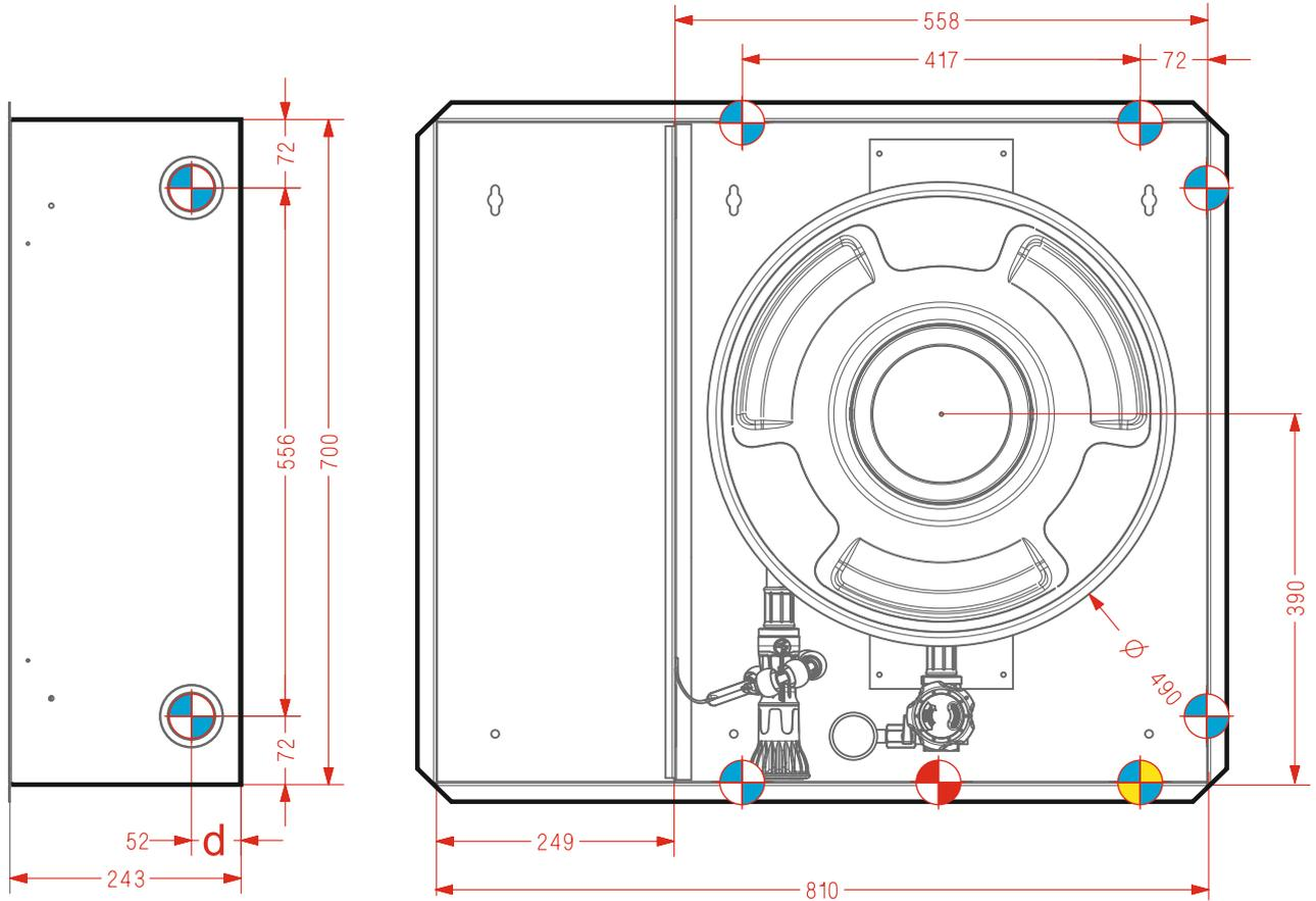
**DIMENSIONES DEL HUECO PARA INSTALACIÓN EMPOTRAMIENTO**
