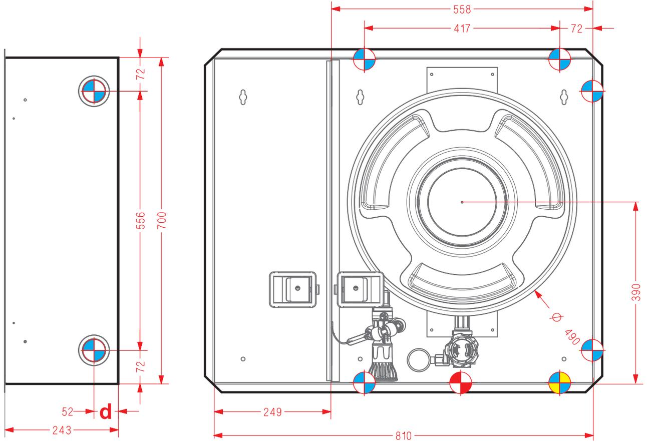
**DIMENSIONES DEL HUECO PARA INSTALACIÓN EMPOTRAMIENTO**
