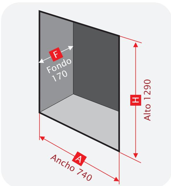
**DIMENSIONES DEL HUECO PARA INSTALACIÓN EMPOTRAMIENTO**
