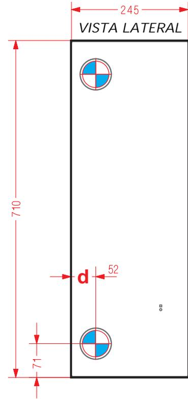
**DIMENSIONES DEL HUECO PARA INSTALACIÓN EMPOTRAMIENTO**
