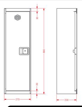
DIMENSIONES DEL HUECO PARA INSTALACIÓN EMPOTRAMIENTO
